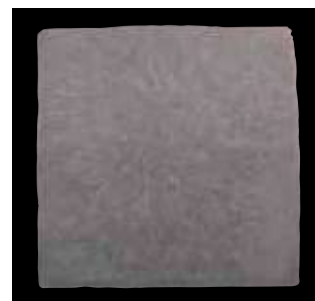
Rissfreier Knüppel im Schnitt
