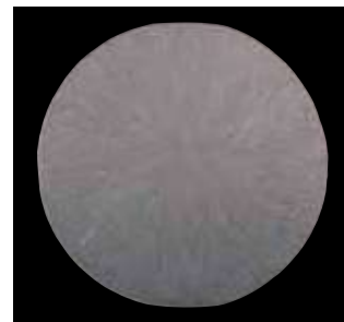
Rissfreies Rundformat im Schnitt
