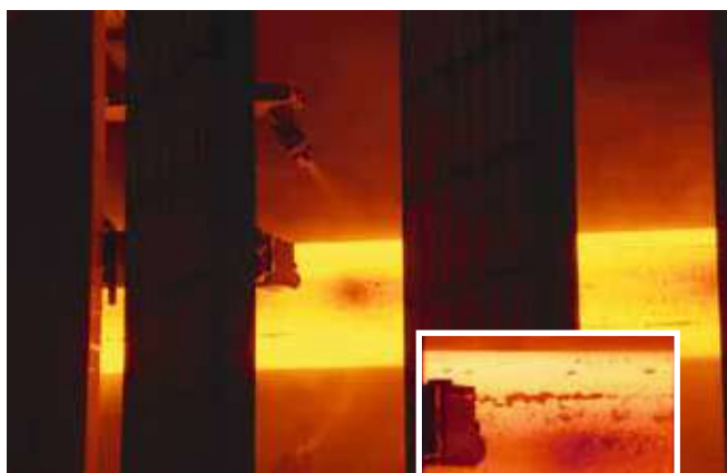
Rundformat mit Überkühlung in der Mitte
