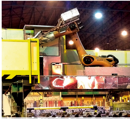
Tüm döküm yollarda kütük baş/kuyruk etiketleme
