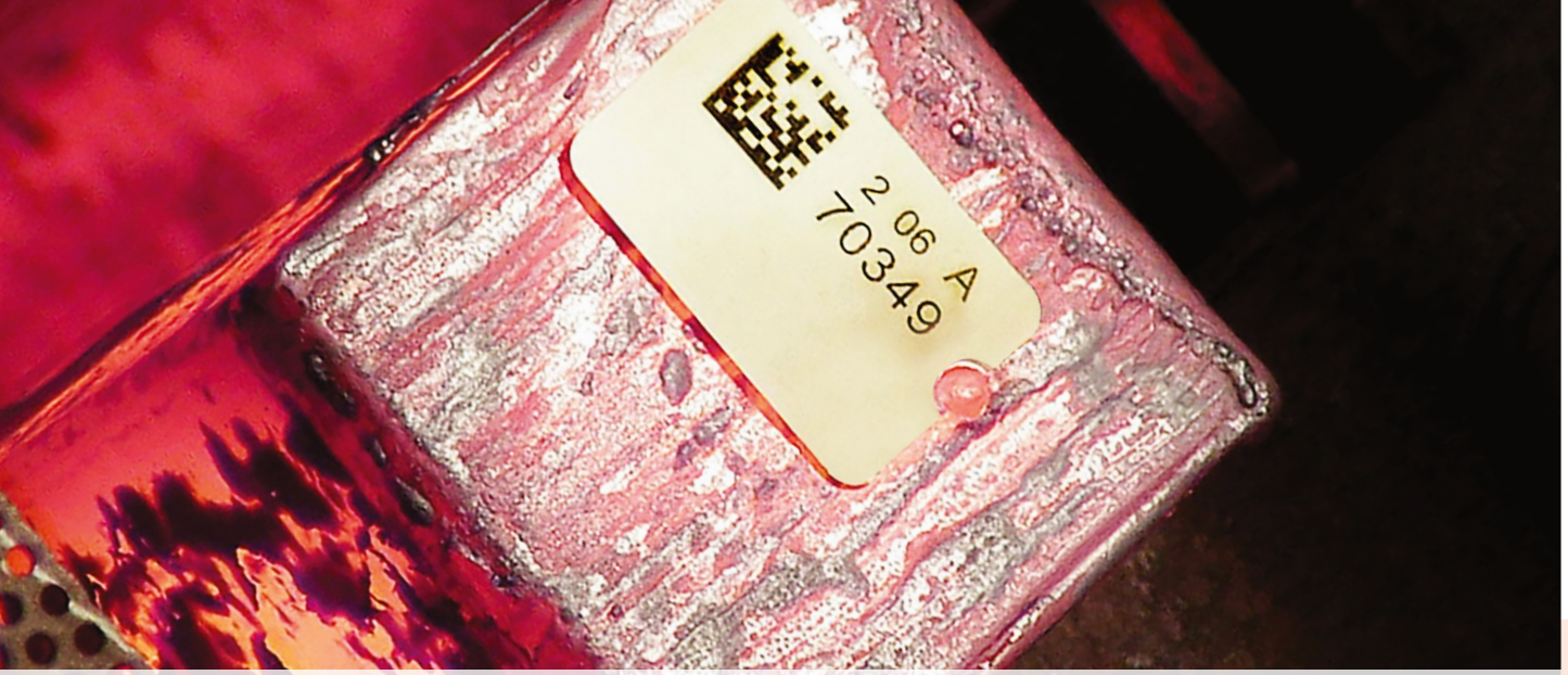
MIG kaynağı ile monteli etiket
