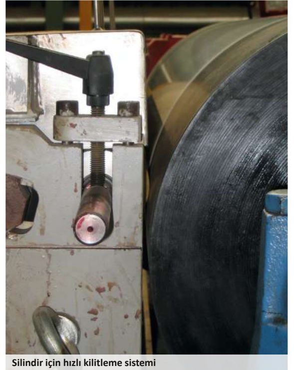
Silindir için hızlı kilitleme sistemi
